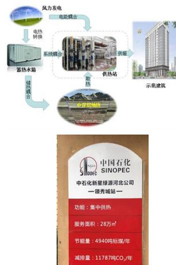
图2 含水层储能系统原理及示范现场
